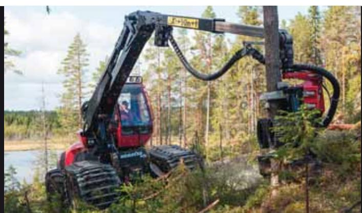
La solution unique avec la grue placée au milieu de la machine et l'interconnexion entre les vérins d'inclinaison et l'essieu oscillant permettent d'obtenir une stabilité supérieure.
