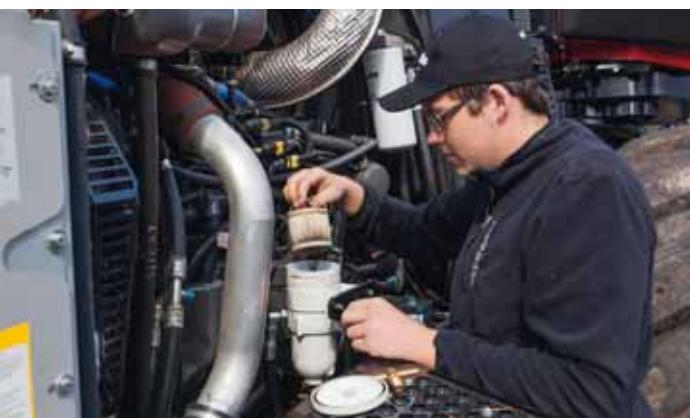
De nouveaux avantages pour la maintenance, entre autres des filtres plus faciles d'accès, un volet séparé pour le remplissage de diesel et d'huile hydraulique et un système de cassette pour un réglage plus rapide des vannes.
