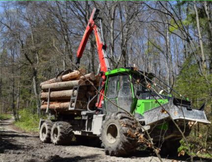
NF170-6R - 10 t de charge, 180 kN de force de traction Un combiné robuste, stable, compact et puissant
