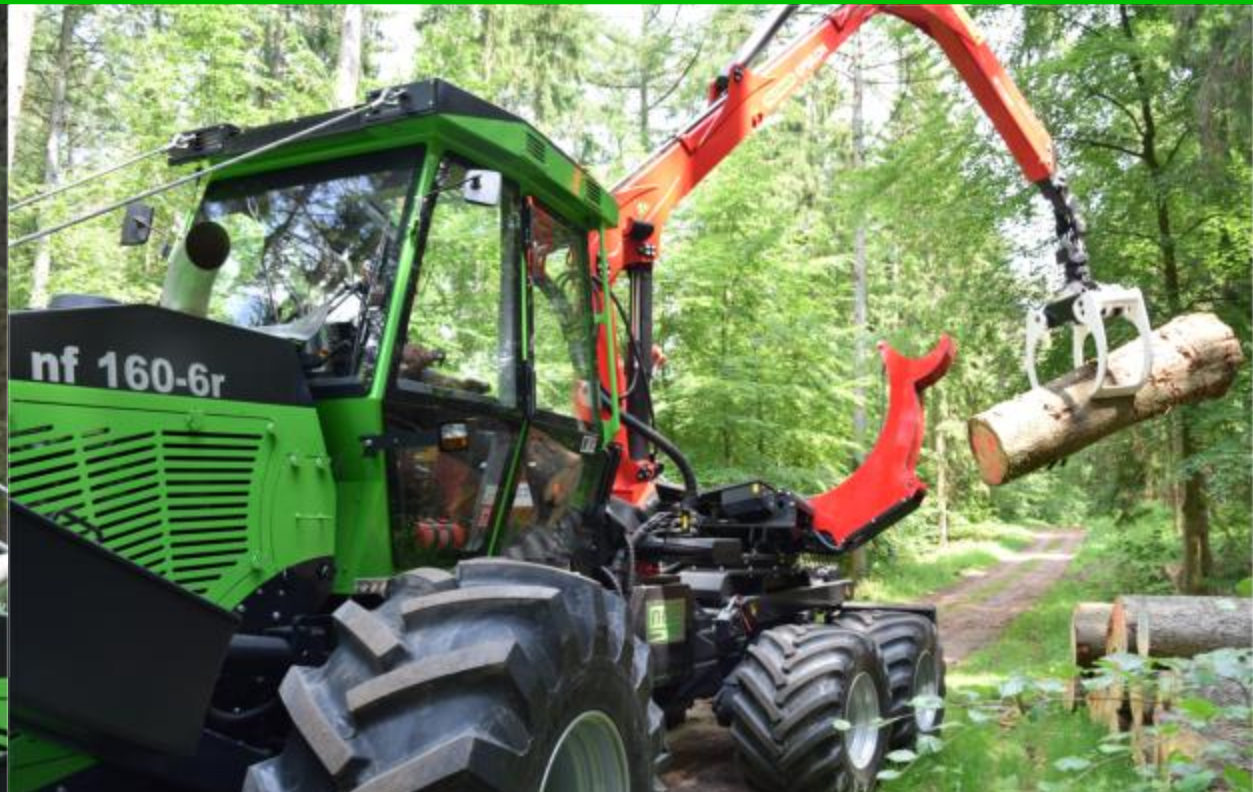
NF160-6R - 8 t de charge, Klemmbank de 1.75 m 2 , Panier de 18 m 3 Rapide, compact, habile, Moteur 6 cylindres
