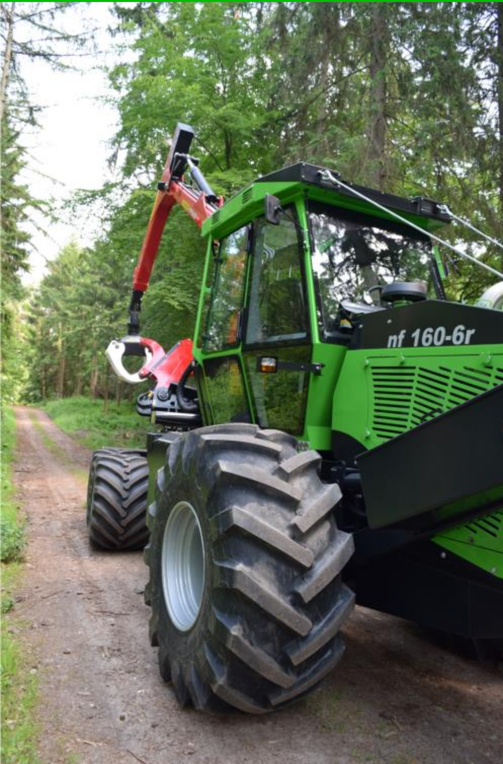
NF160-6R - 8 t de charge, Klemmbank de 1.75 m 2 , Panier de 18 m 3 Rapide, compact, habile, Moteur 6 cylindres
