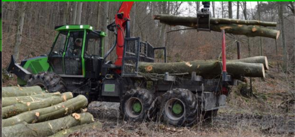
NF160-6R - 8 t de charge, Klemmbank de 1.75 m 2 , Panier de 18 m 3 Rapide, compact, habile, Moteur 6 cylindres
